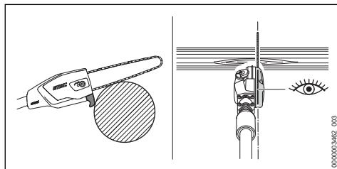
Направляющую в зоне корпуса довести до прилегания к сукну и провести продольную распиловку сверху вниз — не допускать заклинивания пилы в разрезе. Пильную цепь можно точно отрегулировать с помощью регулировочной пластины.
