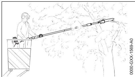
Благодаря большому радиусу действия высотореза с помощью подъёмной платформы можно резать сучья прямо на стволе, не повреждая при этом другие сучья подъемной платформой. Угол наклона зависит от положения сучьев.
