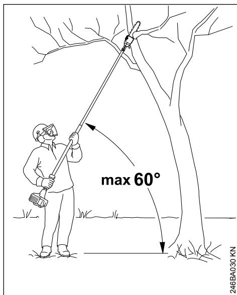
Мотоустройство держать под наклоном, не стоять непосредственно под отпиливаемым сучком. Не превышать угол 60° к горизонтали. Следить за падающими вниз обрезками древесины.
