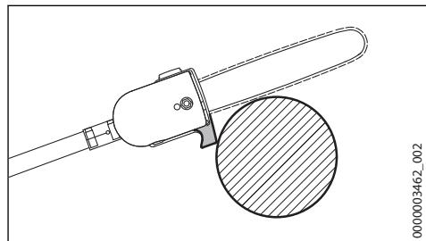
При продольной распиловке шину в зоне крючка установить на сучок до прилегания. Это поможет избежать обратных движений мотоустройства в начале продольной распиловки.
