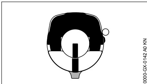
Запорное устройство бака зафиксировано
